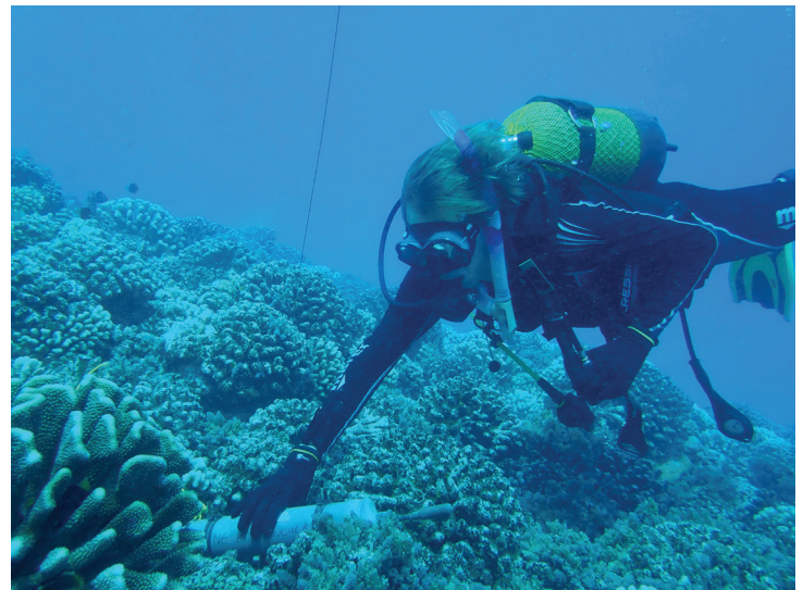
Figure 1 : Un plongeur pose un enregistreur acoustique sur le récif corallien de Moorea (Polynésie française) pour enregistrer les sons des poissons (© K. Eustache).
